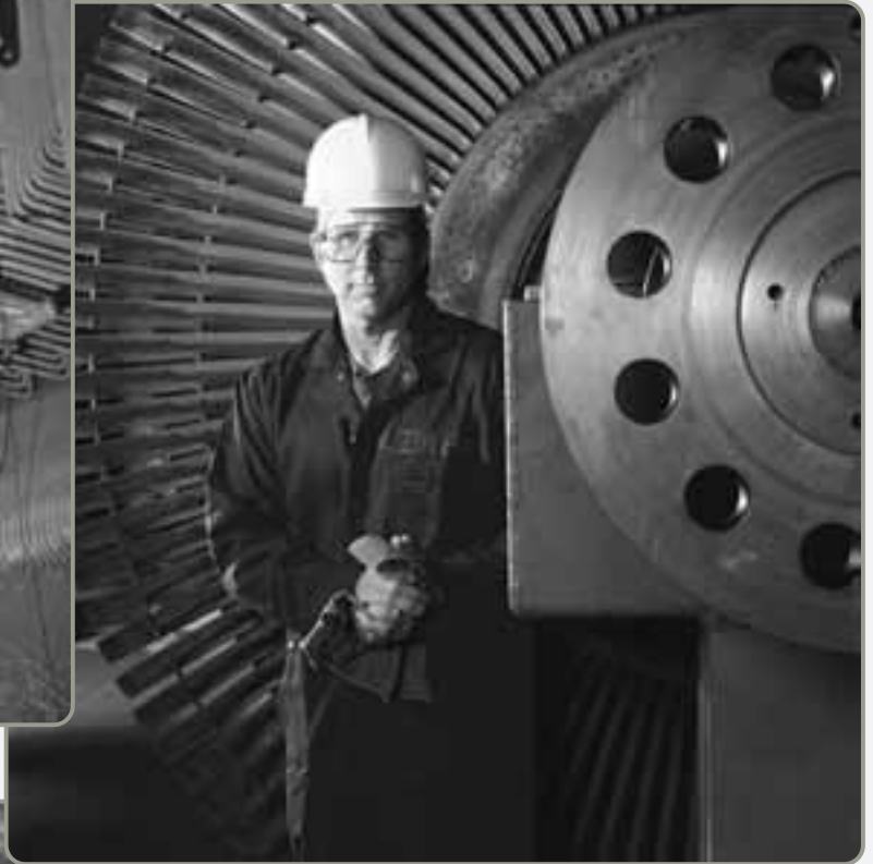
▲ Este inspector examina una sección de turbina a baja presión. Las puntas de esta turbina de aspas giran a velocidades supersónicas de 1,300 millas por hora cuando las plantas están en operación. Una fractura en una de las aspas puede causar fallas catastróficas.
